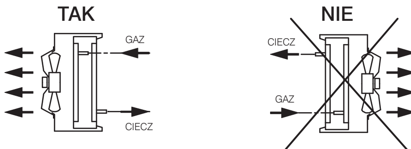
Rys. 3 Instalacja z przepływem poziomym
